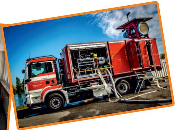
Mit diesem Einsatzgerät wird mittels eines Düsentriebwerkes ein Wassernebel erzeugt, um gefährliche Dämpfe zu binden.
